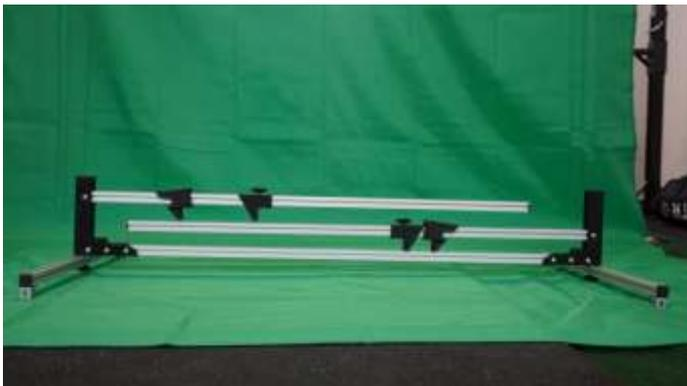
Klappe das obere Profil auf (aufpassen auf die Verriegelung)
