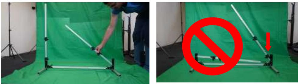
und stecke die Verriegelung über die Führung
